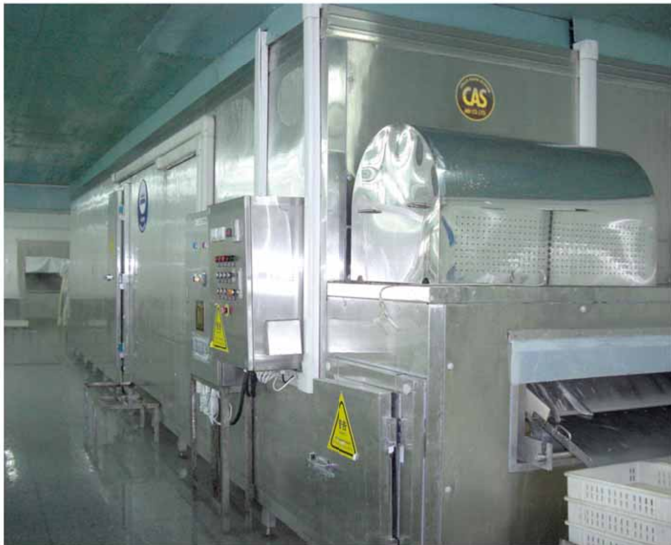
トンネル式フリーザー
